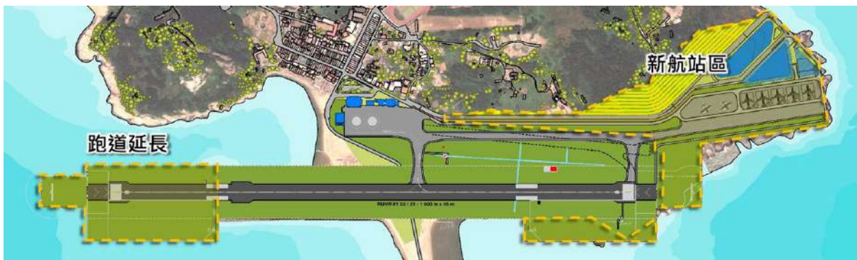
圖13 北竿機場跑道改善規劃配置示意圖 資料來源：北竿機場跑道改善評估及綜合規劃期末報告
