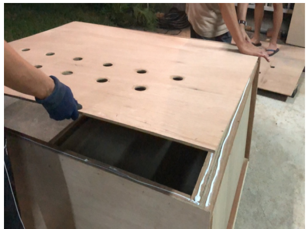
圖四、將側板結構，並使用結構膠加強固定。
