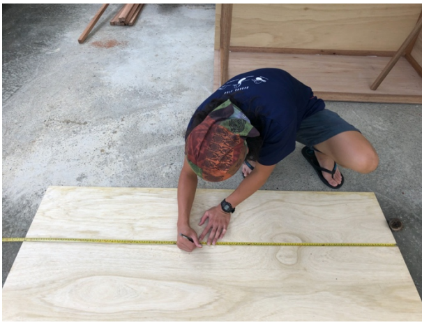
圖一、製作鹿隻運輸箱，依照設計尺寸丈量。
