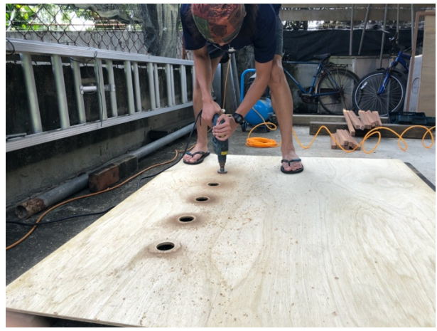
圖二、於運輸箱側板鑽孔洞，使運輸箱能有效通風。
