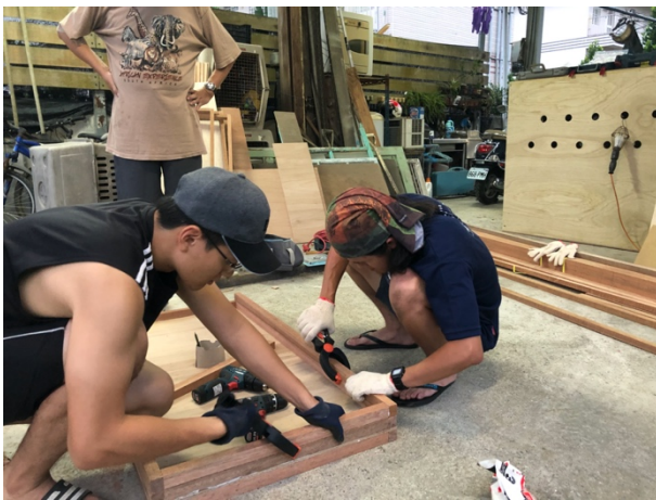
圖三、將運輸籠木條與木板結構穩固。
