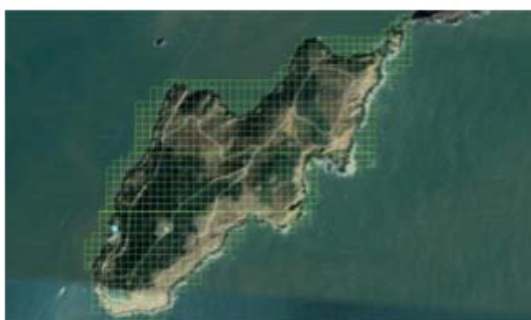
DJIGSPro執行航拍作業
