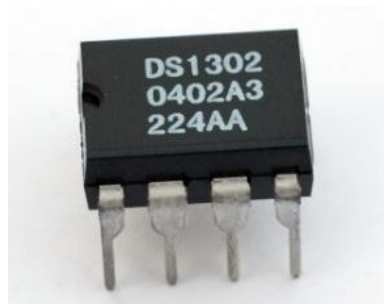
圖 3-32 實時晶片 DS1302 可提供系統現實世界時間
