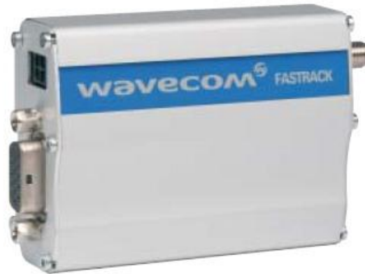
圖 3-31 GSM 可將感測資料利用 SMS 服務送回遠端資料庫
