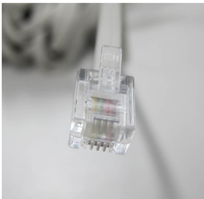
圖 3-35 TX-10U 風速計的 6P4C 接腳
