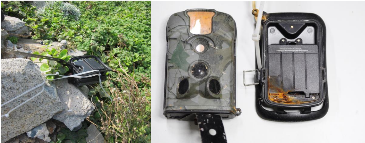
圖 4-22 遭強風吹倒而進水的自動照相機
