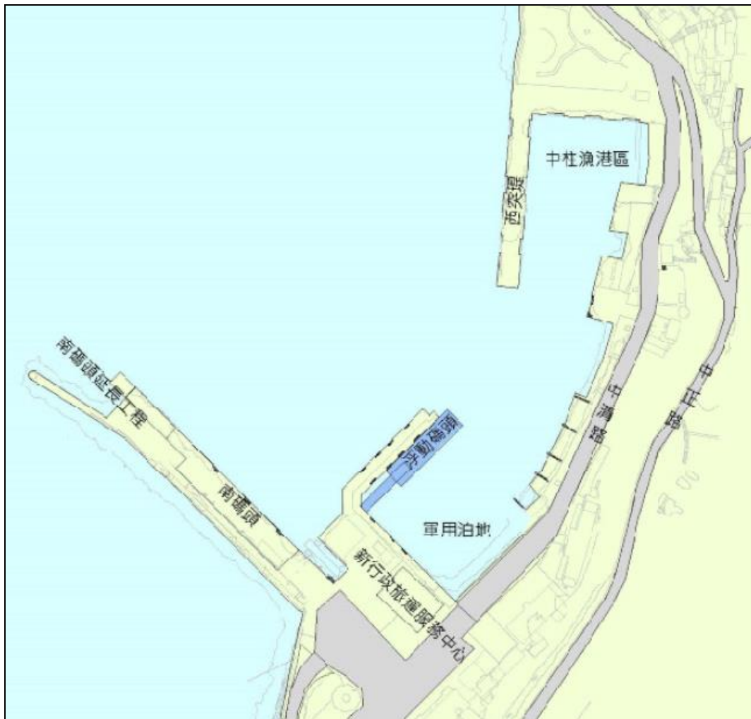
圖 3-9 馬祖港中柱碼頭區新建浮動碼頭配置構想
